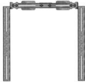
Système de fixation par oblong
